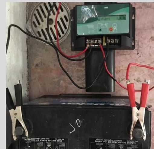
**Figura 3.** Conexión del sistema generador de electricidad, *Fuente: elaboración propia.*
